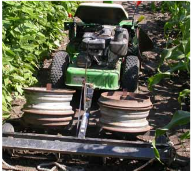
Ogräshacka som ursprungligen varit avsedd för grusgångar. Ett järn som är vinkelrät mot radens riktning skär genom jorden på några centimeters djup. Foto: Johan Ascard.
