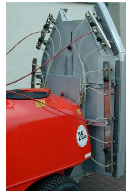
Plåt som stänger av luftströmmen för sprutning helt utan luft åt ena sidan.
